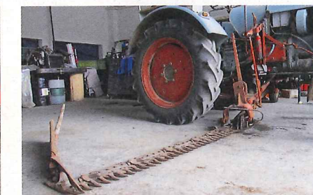
... Jahren und funktioniert zu unserer Freude einwandfrei. Der Messerbalken senkt sich, bis er parallel zum Boden in der Luft hängt. Die ...
