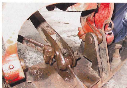
... geschwenkt und abgenommen. Dadurch ist der Druck der Kopfbänder auf den Kugelkopf der Messerschiene aufgehoben. Statt ...
