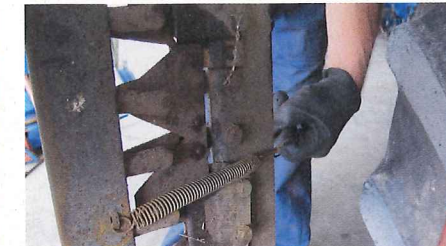
... Antriebswelle sitzt – in der „Trommel“. Wir beginnen mit dem Abnehmen des Fingerschutzes, von den zwei Haltefedern ist nur noch die untere ...
