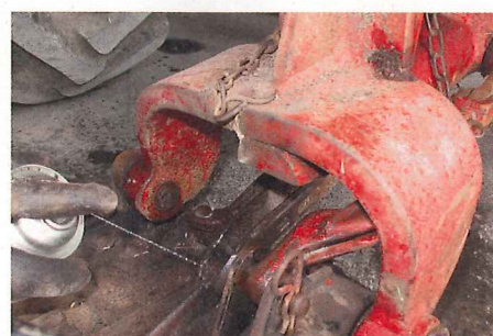
... Kopfbänder (eins mit Zapfen) und der Kugel am Messeranfang mit Rostlöser. Das wirkt den Jahren des Stillstands entgegen. Es folgt das ...
