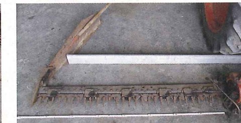
... darf keineswegs parallel zur Schiene liegen, das hieße Voreilung gleich null. Vielmehr muss die äußere Spitze des Messerbalkens ...
