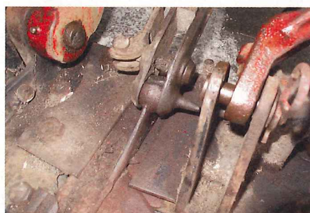
... ja spätestens im nächsten Jahr nutzen wird. Weiter geht es mit dem Einsprühen der beiden Scharnierbolzen am Innenschuh sowie der ...
