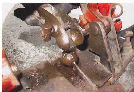
... sollte man lieber die Zylindermutter der Spannschraube ein bis zwei Umdrehungen aufschrauben, dann geht es leichter von der ...
