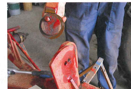
... ohne die Demontage dieses Stellhebels der Haltebügel nicht vom restlichen Gestänge des Mähwerks lösen. Zum besseren Arbeiten ...
