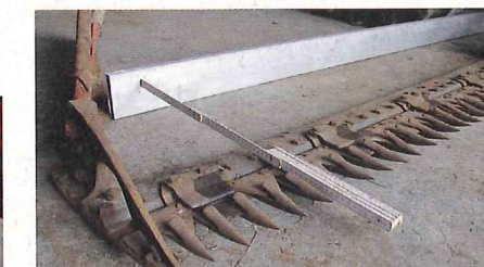
... hinausragt und misst nach – und zwar innen und außen am Balken, jeweils von der Schiene bis zur Spitze eines Mähfingers. Der Balken ...
