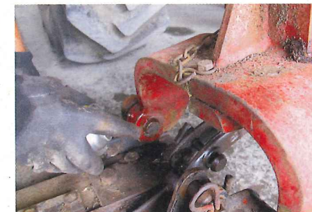
... lediglich abgeschmiert. Auseinandernehmen, reinigen und neu versplinten ist hier nur bei einer Komplettrestaurierung obligatorisch
