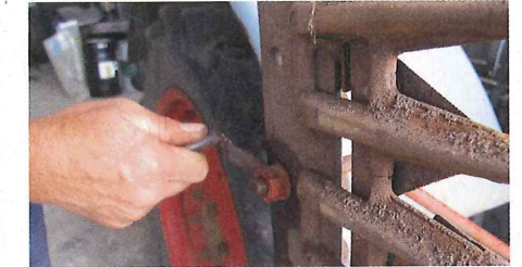
... vorhanden. Es folgt die Haltestange für den Mähbalken, dazu muss eine Kurbel abgeschraubt werden. Diese Transportsicherung entfernt ...
