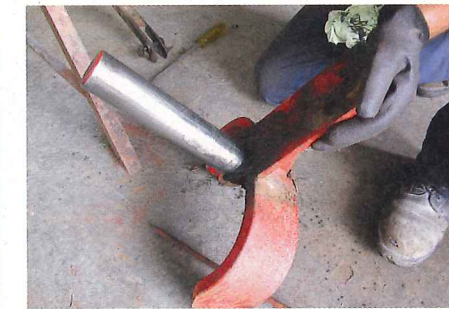
... Bügel aus seinem Halte- beziehungsweise Führungsrohr. Der massive Haltebolzen sieht sehr ordentlich aus – keine Schmutz, kein Rost
