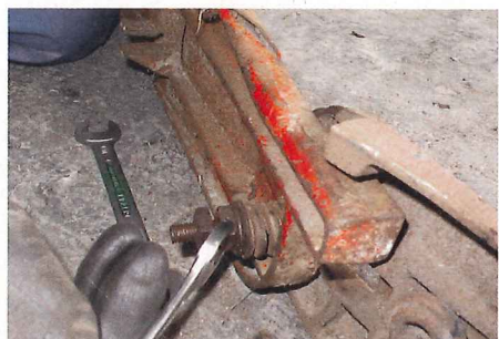
... erzielen. Die Demontage geht weiter mit dem Abnehmen des äußeren Schwadblechs. Dazu wird zunächst die Konterung der ...
