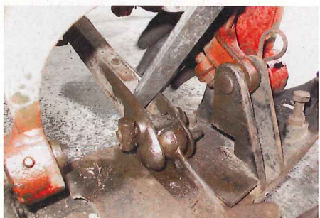
... der Messer-Kugel zu schieben. Dabei leisten die Spanngabel oder ein Montiereisen gute Dienste. Eh man zu große Gewalt anwendet ...
