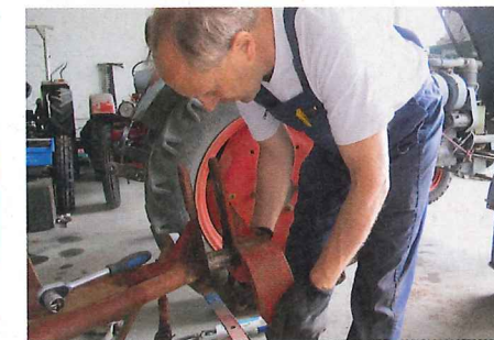
... hat Thomas die komplette Antriebseinheit des Mähwerks auf zwei Böcke gelegt. Unter leichtem Hin- und Herdrehen zieht er den ...
