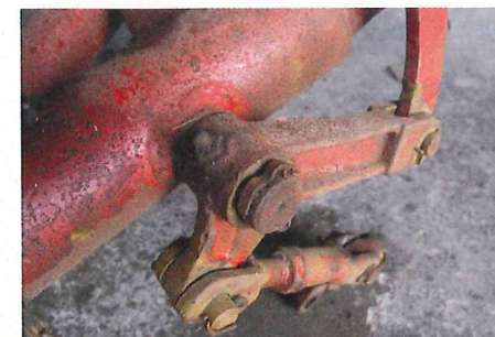
Hier ein Blick auf den Winkelhebel und seine Verbindungsteile. Uns geht es um die Funktion des Mähbalkens, deshalb hat Thomas das Teil ...
