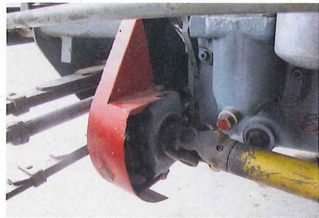
... Scheibenspannung. Die Scheibe sitzt auf der linken Seite hinter einem – hier rot lackierten – Schutzgehäuse, dazu in einem späteren Teil ...
