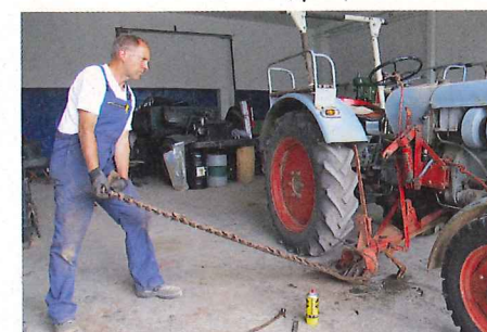
Nachdem die Haltebolzen noch einmal Rostlöser erhalten haben, wird der Balken durch hoch- und runterwippen mit Zug in Richtung ...
