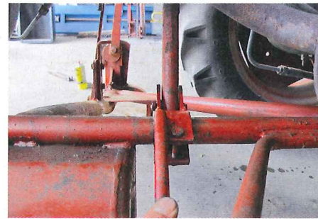
... hin abstützt und so den Tragrahmen des Mähwerks stabilisiert. Danach den Hebel so sich ran ziehen, und die Stütze kann nach ...
