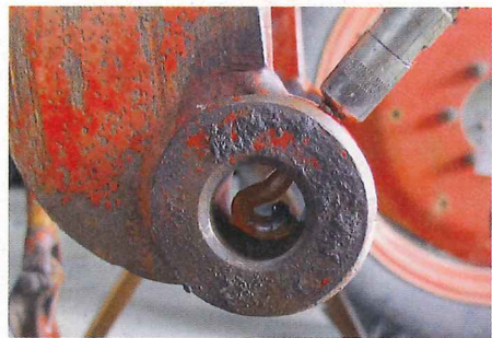
... Schmierfilm muss raus. Nachdem der jeweilige Schmiernippel ebenfalls sauber gewischt wurde, kommt neues Fett in die Bohrungen. Dieses wird ...
