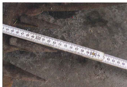
bis 70 Millimeter sein, bei einem 1,8-Meter-Mähbalken werden gar 60 bis 90 Millimeter Voreilung empfohlen. Thomas misst innen ...
