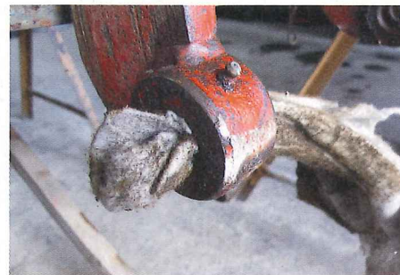
... Haltebügels. Es gilt, die alten verkrusteten Rückstände aus Fett und Schmutz zu entfernen. Die Bohrungen selbst sehen gut aus, nur der alte ...
