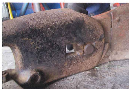
... Muttern gelöst, anschließend dreht man diese so weit, bis sich der Schraubenkopf aus seinem Sitz nach vorne schieben lässt, wo ...
