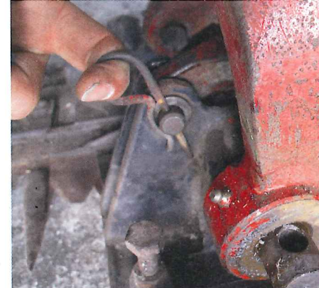
... herausziehen. Dazu kommt der Vorstecker, der die Verbindung des Innenschuhs mit dem Winkelhebel sichert. Für alle Splintarten ...
