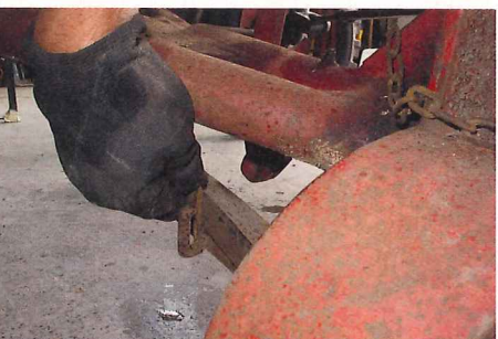
... Abnehmen der Spanngabel. Sie wird aus ihrer Arretierung seitlich der Kurbelstange genommen und in Richtung Mähbalken ...
