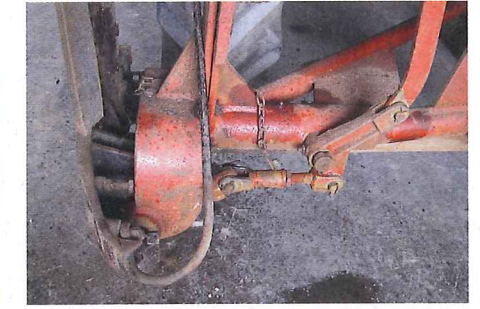
... nötigen Öldruck. Hier sieht man den Bügel mit Schnellverschluss, der den Mähbalken hält sowie den mehrteiligen Winkelhebel
