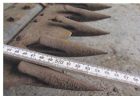
knapp 54 Millimeter und außen 55 Millimeter – eigentlich zu wenig für den 1,5-Meter-Balken, um später ein optimales Schnittergebnis zu ...
