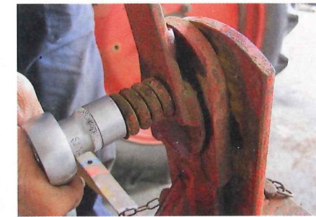
... dafür, dass er zu schwergängig ist oder sich überhaupt nicht rührt. Hier ist auf jeden Fall Entrostan angesagt, außerdem lässt sich ...
