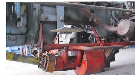
Die vorn über einen Keilriemen angetriebene Gelenkwelle greift in das Lagergehäuse, an dessen Ende die Kurbelstange auf der ...
