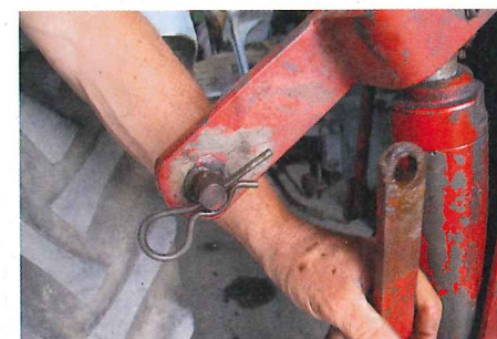
... der die Verlängerung des Winkelhebels mit der Hubgabel des Hydraulikkolbens verbindet. Der Mähbalken kann nun abgenommen werden
