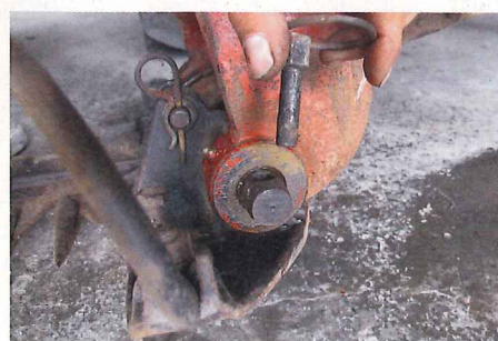
... Hand. Bleiben noch die beiden Klappsplinte von den Scharnierbolzen des Innenschuhs, sie lassen sich dank Rostlöser ohne Hammerschlag ...
