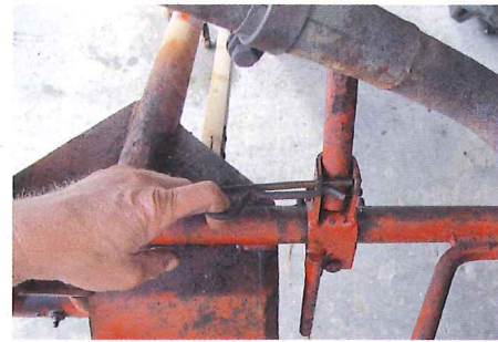
Und wieder wird ein Splint gezogen: Dieser sichert die Stütze, die sich am Gehäuse zwischen Getriebe und Kupplungsglocke nach oben ...
