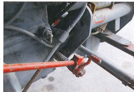
... gehörende Gestänge verbleibt am Traktor. Im Bild ein Teil des Abschaltgestanges und die Kurbel zum Verstellen der Keilriemen- ...
