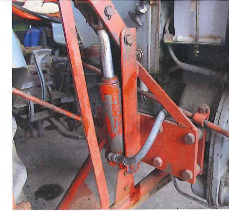
... war dabei ebenfalls schon mal Thema eines Berichts. Sie versorgt den Zylinder (Hub 122 mm, Einbaulänge 304 mm) des Aufzugs mit dem ...
