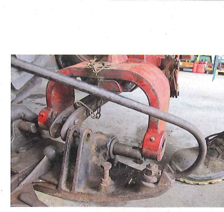
... erforderlich – am Gewinde eingestellt, in Position gebracht und durch seinen Splint gesichert. Danach kann bereits wieder der ...
