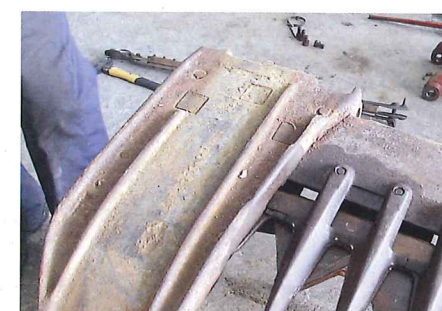
... dritten Finger liegen – aber nur bei besagtem Mittelschnittbalken. Hier sieht man die drei versenkten Vierkantköpfe der Schrauben ...
