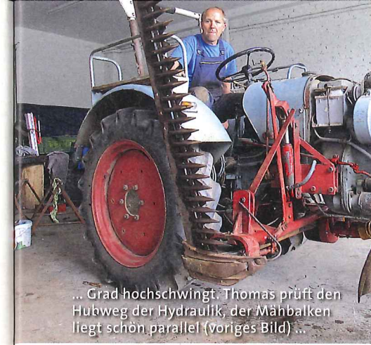
... zum Boden. Den „Höhenanschlag“ dreht er ein wenig raus, da ihm der Balken für seinen Geschmack etwas zu weit entgegenkippt
