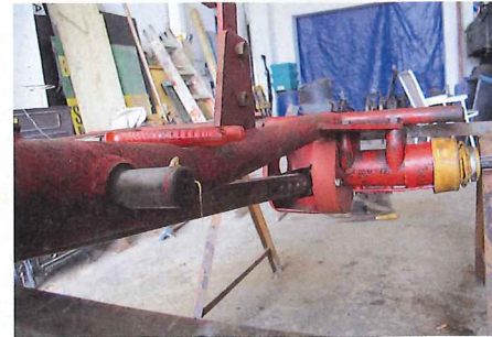
Thomas hat den Winkelhebel schließlich doch abgenommen, um den Zustand des Bolzens zu kontrollieren. Erstaunlicherweise ist er ...
