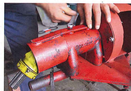
Beim Anbringen des „Gelenkschutzes“ überlegt Thomas noch kurz, ob der Knick in der Lasche sein muss. Da die Antriebswelle ja von oben ...
