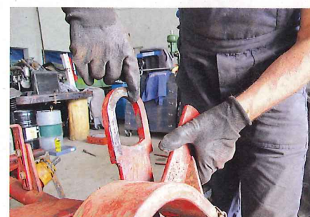
... für die Schnittwinkelverstellung fettet Thomas alle Verbindungsflächen ein. Damit stellt er sicher, dass alles „reibunglos“ läuft – auch ...
