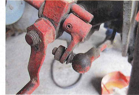
Weiter geht's mit dem Hebelmechanismus zum Spannen und Freigeben des Keilriemens. Der Hebel wird über ein Gestänge vom Fahrersitz ...
