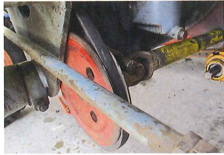
... Winkelgelenks nicht in Ordnung. Bei gelöstem Gelenk lässt sich die Laufscheibe weit genug rausziehen, um einen neuen Keilriemen ...
