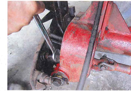
... zum Boden. Den „Höhenanschlag“ dreht er ein wenig raus, da ihm der Balken für seinen Geschmack etwas zu weit entgegenkippt
