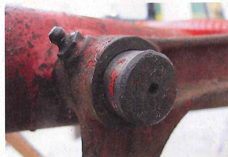
Schläge statt Schmiere: Wie bereits erwähnt, hat die Mechanik im Feld mal geklemmt, war der Bauer schnell mit dem Hammer zur Hand
