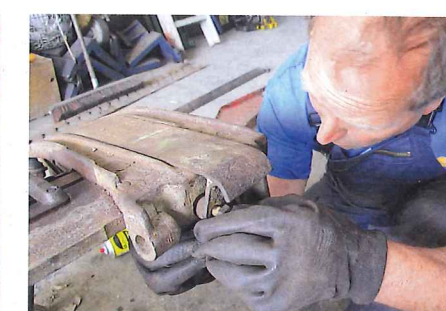
... die den Innenschuh halten. Sie wurden ja nur gelöst, um den Messerhalter abnehmen zu können. Thomas Geis befestigt zunächst ...
