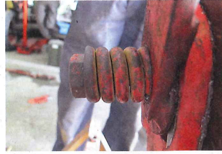
... beibehalten bleibt. Die Schraube wird so fest eingedreht, dass sie die Feder fast komplett zusammendrückt. Getestet wird später, steht ...
