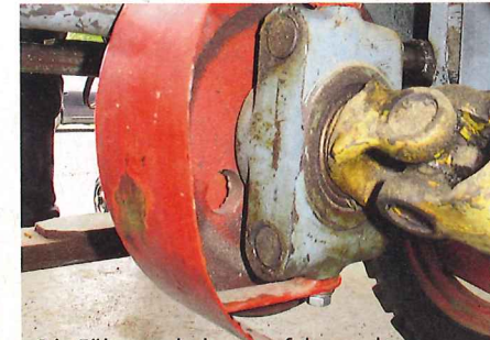
Die Führungsbolzen, auf denen das Lagergehäuse läuft, erhalten etwas Öl, das Schutzgehäuse wird angebaut
