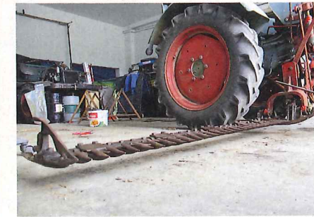
... Waagrechten eingestellt, die Schraube rechts auf dem Innenschuh ist der vertikale Anschlag. Sie verhindert, dass der Balken weiter als 90 ...
