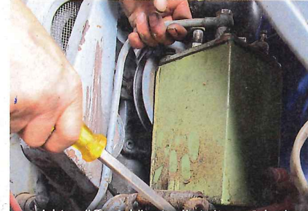
... nicht geöffnet, könnte die Leitung Schaden nehmen. Etwas „anlüften“ reicht bereits, um den Keilriemen rausziehen zu können
