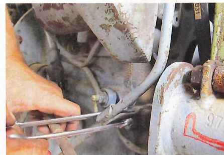
... gespannt werden. Nur so ist gewährleistet, dass die Hydraulikleitung spannungsfrei liegt. Eventuell muss man sie etwas „nachdrücken“
