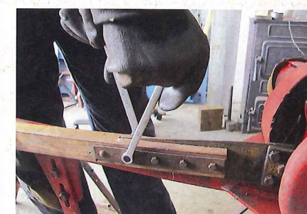
... Stange verlängern oder kürzen, bis die Mitte der zweiten Klinge in der dritten Fingerspitze liegt (Mittelschnittbalken). In der Regel muss ...
