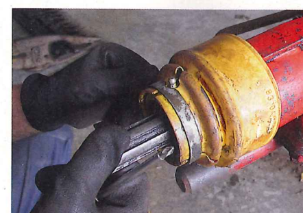
... kommt, hat der Knick seine Berechtigung. Bei der Schutzkappe beziehungsweise Manschette ist auf die richtige Lage der Schelle zu achten
