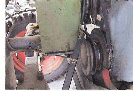
... zu entfernen. Zwischen Hydraulikpumpe und der entsprechenden Riemenscheibe auf der Kurbelwelle ist kein „Durchkommen“
