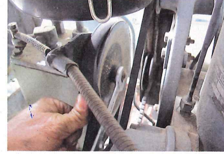
... den Keilriemen. Sobald die Pumpe sinkt, lässt sich der Riemen von der Laufscheibe drücken. Aber das reicht noch nicht, um den Keilriemen ...
