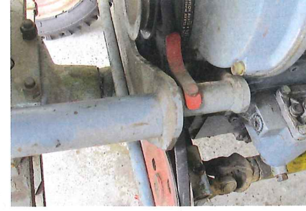
... der Mähbalken angetrieben, weist der Hebel nach unten, steht das Messer still; der Blick von oben auf den eingebauten Ersatzriemen
