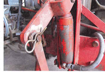
... zwischen den Bändern nachgestellt werden. Der letzte Akt bei der Montage des Balkens ist das Einhängen und Sichern des Winkelhebels ...
