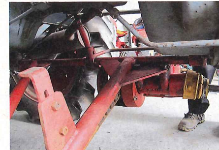
Nun ist es auch an der Zeit, den Halterahmen des Balkens samt Messerantrieb wieder unter den Eicher Panther zu hängen. Ein zweiter ...
