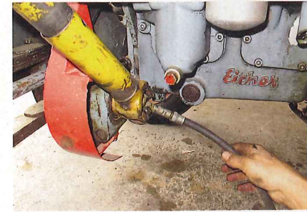
... einmal die jeweiligen Enden und versorgt das Kreuzgelenk auf dieser Seite der „Anlage“ mit frischem Fett. Es wird gepumpt, bis ...
