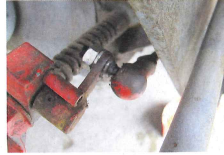
... aufzulegen. Danach hat Thomas den Hebel etwas gerichtet und das Gelenk mit Neuteilen wieder verschraubt. In dieser Stellung wird ...
