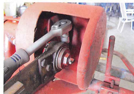
Die Kurbelstange wird gleich richtig angezogen, die „Einstellung“ des Messers auf den richtigen Innen- oder Außenhub ist ja praktisch durch ...
