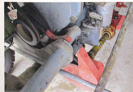
... sieht man auch schön, wie die Sicherungskette zu hängen hat. Ein erster Probelauf zeigt, dass alles sauber läuft: Welle, Riemen, Messer etc.
