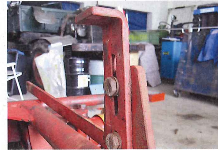
Der Gewindebolzen (links mit Feder) wird normalerweise von dem Bügel im Bild gegen den Handgriff gedrückt, mit dem man den ...
