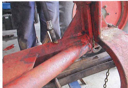
... lediglich eine Konterfunktion. Sind Bügel und Verstellhebel angebaut, kommt eine ordentliche Ladung Fett in das Aufnahmerohr
