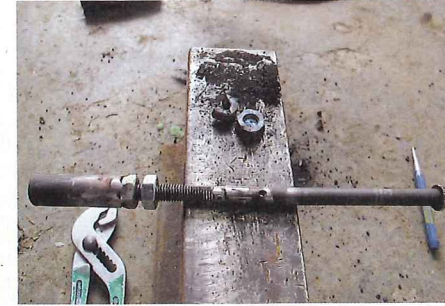
Hier das „Neuteil“: Die untere Hälfte bis zum Splintloch und das Stellstück hat Thomas wiederverwendet, Gewinde und Muttern ...
