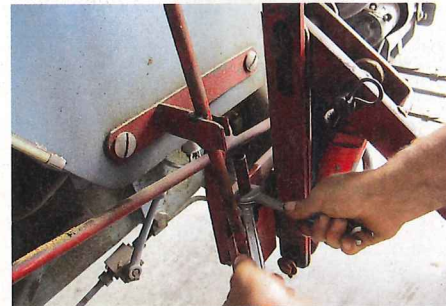
... Antriebskeilriemen einrückt. Doch der Bolzen ist verbogen, das Stellstück am oberen Ende schießt an der Lasche der Griffstange vorbei
