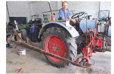
Das mehrmalige Anheben und Absenken des überholten Mähbalkens – auch bei laufendem Messer – zeigt, dass die Anlage „trocken“ ...
