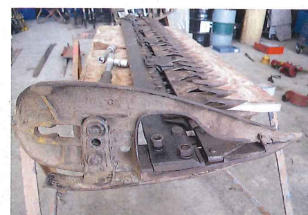
... wieder die Sohle. Beim Außenschuh ist das nicht nötig, da das Teil nicht abgebaut worden war. Beide Sohlen sind höhenverstellbar
