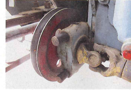
... an der Hydraulik. Bleibt das Einlegen eines neuen Keilriemens: Den alten zu zerschneiden war ein Klacks, jetzt ist etwas mehr gefordert
