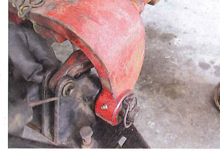
Der Klappsplint ist schnell gesetzt, bleibt noch der Winkelhebelmechanismus: Bolzen stecken, Splint einsetzen, Sicherungsring umlegen
