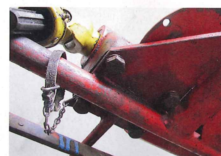
Mit dem Tragrahmen geht die Arbeit weiter: Der Kurbeltrieb wird aufgesetzt und mit vier Schrauben fixiert. Dabei sollten auch neue ...
