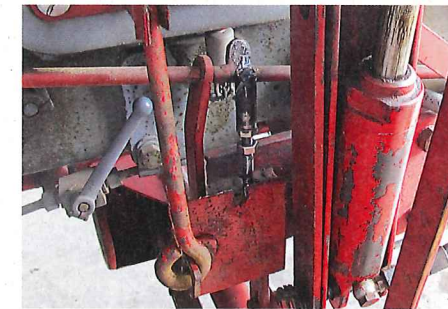
... einwandfrei läuft. Alle Geräusche zeugen von normaler Funktion, und auch die Sicherung greift und schlägt gegen die Lasche vom ...
