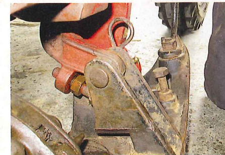
Falls nötig wird jetzt auch der Balken justiert. An der schräg liegenden Schraube mit Mutter am Winkelhebel wird der Balken in der ...
