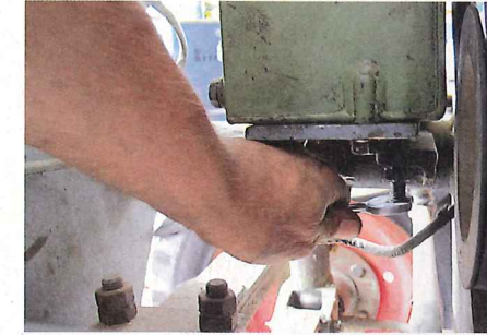
Das Prozedere beginnt mit dem Lösen der Spannschraube unter der Hydraulikpumpe des Eicher. Die Neigung der Pumpe spannt ...
