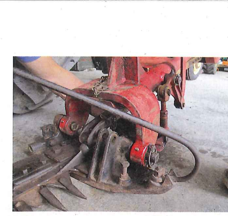
... Mähbalken in den Bügel gehängt werden. Die Bolzenaufnahmen hatte Thomas ja gleich bei der Demontage neu gefettet, es flutscht also
