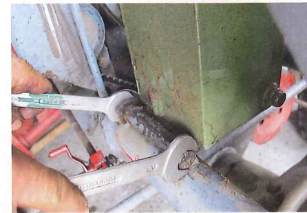
Erst wenn diese Arbeiten alle erledigt sind, wird die Scharnierverbindung der Pumpen-Grundplatte festgezogen. So weit, so gut
