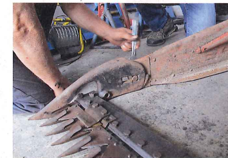
... Handgestänge. Bleibt nur noch das Anbringen des Schwadblechs. Etwaiges Entrostet und Lackieren haben wir hier außen vorgelassen
