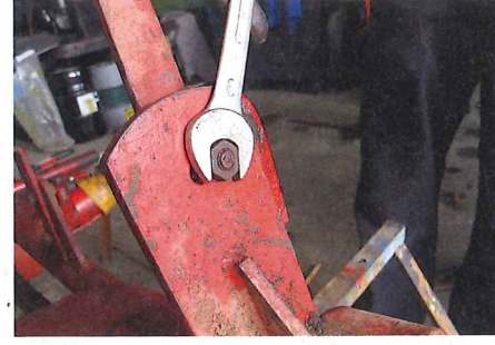
... der Hebel dann nicht genug unter Spannung, um die gewählte Stellung zu halten, muss die Feder erneuert werden. Die Mutter hat hier ...
