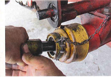
... sauberes Fett aus den Lagern quillt. Dann erfolgt das Aufstecken auf das Keilwellenende des gegenüberliegenden Kreuzgelenks. Hier ...
