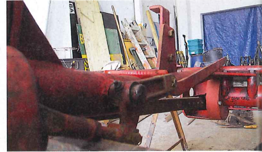
... nicht eingelaufen. Reinigen, Abschmieren und neu Versplinten reichen hier völlig aus, damit der Hebel möglichst ruckfrei arbeitet
