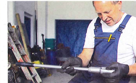
Thomas nimmt für diese Schraubarbeit eine große Zollratsche. Natürlich tut es auch ein Stück Rohr auf einer normal großen Ratsche
