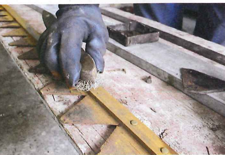
... ebenfalls unproblematisch, da das Band frei über den hinteren Teil der Finger läuft. Für die Funktion reicht es, den größten Rost mit ...
