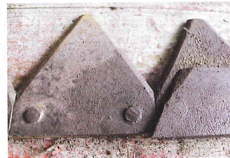
... (oder Druckplatte), die hier bei diesem Rasse-Mähwerk auf jeder vierten Klinge aufgenietet ist, beschädigt. Es sind lauter kleine Ursachen ...
