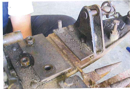
Den Innenschuh des Fingerbalkens entfernt Thomas nicht, er löst aber zunächst drei Muttern. Die von unten kommenden Schrauben haben ...
