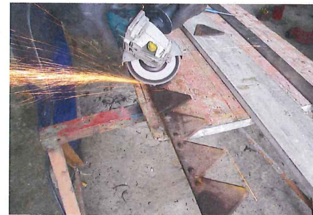
Alternativ zu Hammer und Meißel kann der Niet, der getauscht werden soll, auch mit dem Winkelschleifer „glatt“ geschliffen ...
