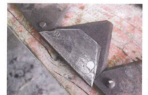
Zudem ist es wichtig, dass die hintere Kante dieser Platten parallel zum Messerband verläuft und den richtigen Überstand hat
