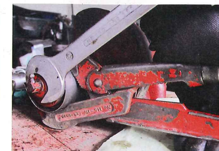
Zum Festziehen kommt unser Blechstreifen wieder zum Einsatz – als Schutzmantel für die Oberfläche des Lagergehäuses. Die ...
