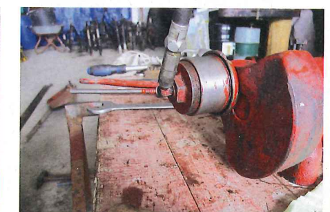
... Bisspuren der Zange richten so keinen Schaden an. Abschließend erhält die Kurbel frisches Fett und wird dann zur Seite gestellt
