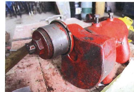
Als nächster Schritt wird der Lagerdeckel erneut eingeschraubt. Das Gewinde hat Thomas vorab mit der Drahtbürste gereinigt und leicht geölt
