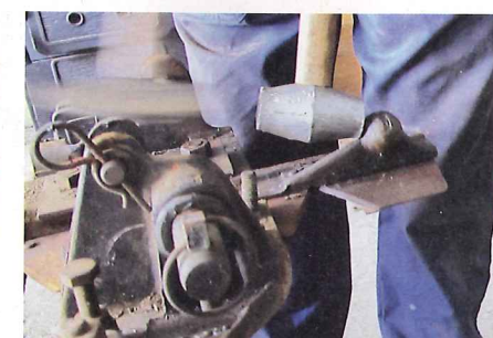
... nicht alle Klingen passgenau sitzen. Um das Messer (so heißt die Schiene mit den Klingen) aus seiner Führung zu bekommen, helfen ...
