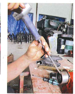
... gehebelt und mit leichten Schlägen gegen eine Flanke der Mutter gelegt. Thomas nimmt dazu einen Aluhammer, einer aus Kunststoff täte es auch
