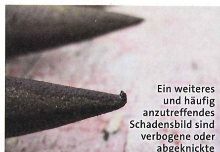
Schäden sind bei alten Messerbalken die Regel, nicht die Ausnahme. Hier sind die Stoßkanten der Finger und der Fingerplatten (gezahnte ...
