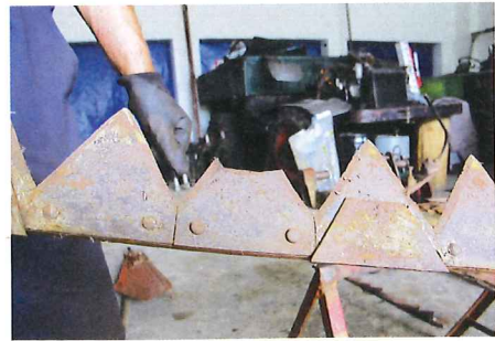
Weitere Schadensbilder: Einige Klingen sind abgebrochen. Der Landmaschinenhandel hält Ersatz parat, die Schneiden sind nur aufgenietet
