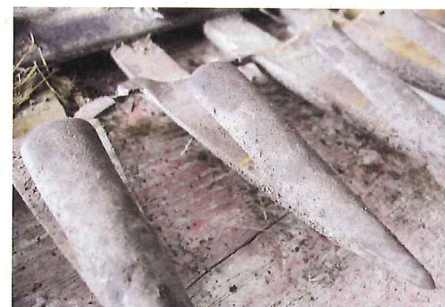
Schäden sind bei alten Messerbalken die Regel, nicht die Ausnahme. Hier sind die Stoßkanten der Finger und der Fingerplatten (gezahnte ...
