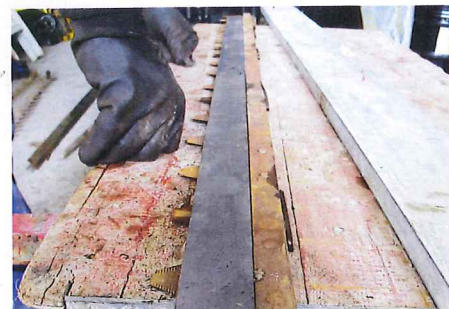
Ist das Messer von der breiten Seite her etwas durchgebogen, geht man ähnlich vor wie beim Fingerbalken – nur reichen hier leichte ...
