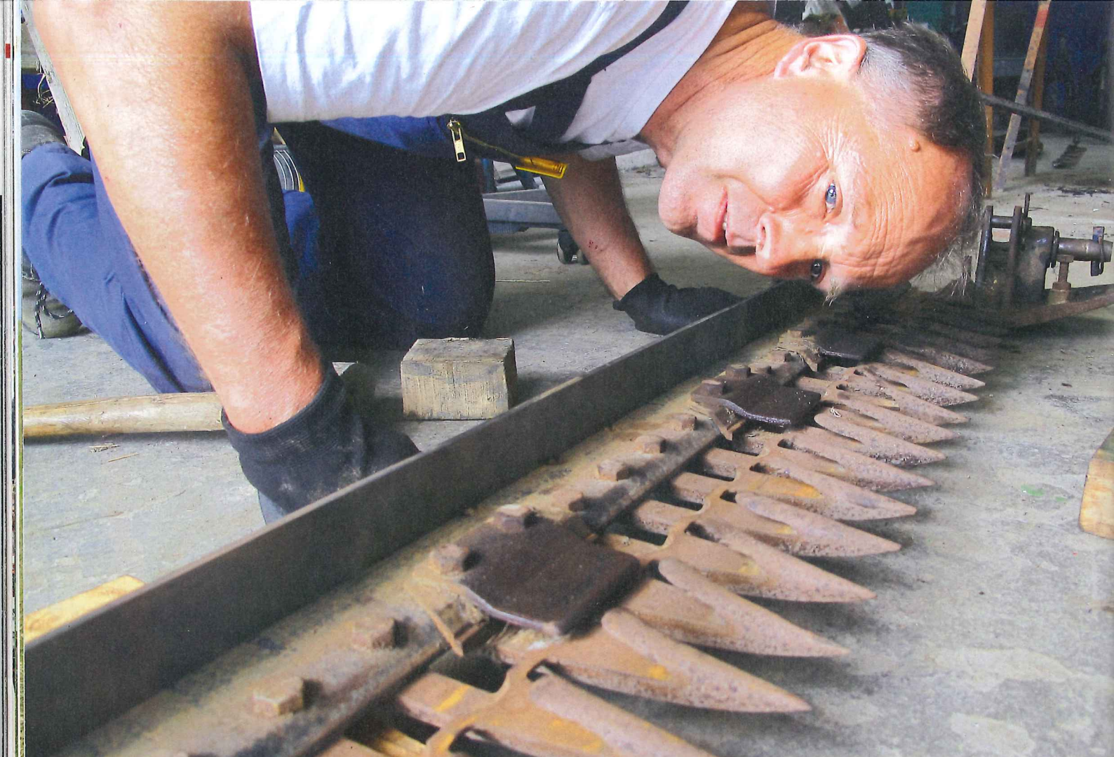
Die Montage geht weiter: Beim Anziehen der Mutter auf der Kurbel, hilft es, einen „Hebel“ als Gegenhalt durch das Kreuzgelenk zu stecken
