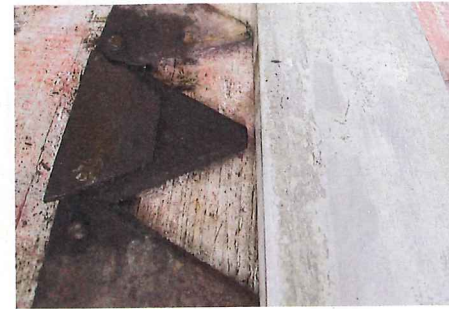
... Schläge mit einem Fäustel. Wer die Schiene an die Klingenspitzen anlegt, erkennt schnell, wo im Laufe der Jahre falsche Klingen als ...
