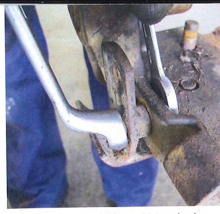
... Zwischenplatte und Führung hinten abnehmen. Nach Lösen dieser seitlichen Verschraubung kann man die Sohle des Innenschuhs entfernen. Für sie ...
