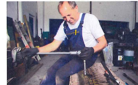
Zum weiteren Lösen der Führungen am Balken ist eine ordentliche Verlängerung angesagt, ohne den Hebel tut man sich unnötig schwer
