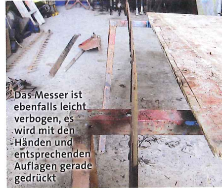
Weitere Schadensbilder: Einige Klingen sind abgebrochen. Der Landmaschinenhandel hält Ersatz parat, die Schneiden sind nur aufgenietet
