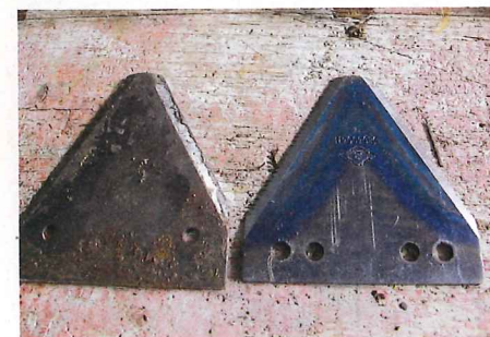
Die Oberseiten der Klingen: An dem Neuteil ist der gehärtete Bereich schön zu erkennen – dort, wo das Metall blau angelauten ist
