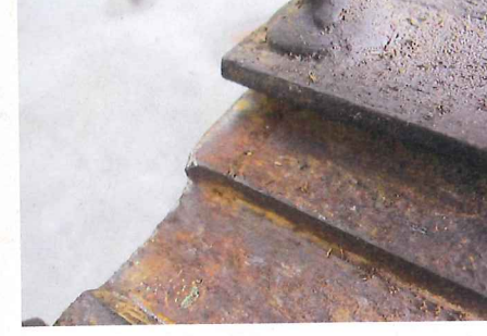
... entfernt Thomas den größten Dreck und entdeckt einen der vielen Gründe, warum das Messer klemmt: Die Führung im Innenschuh ...
