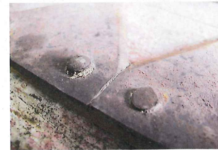
Oben auf dem Messer dürfen die Niete ruhig aus den Klingen herausragen. Nur die Druck- oder Reinigungsplatten haben Kontakt zu ...
