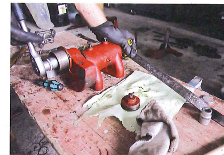
Die Montage geht weiter: Beim Anziehen der Mutter auf der Kurbel, hilft es, einen „Hebel“ als Gegenhalt durch das Kreuzgelenk zu stecken
