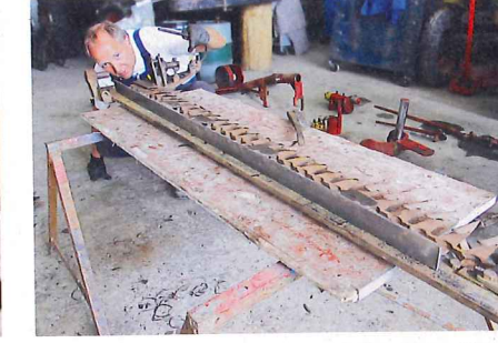
Thomas legt die Schiene praktisch von allen Seiten längs an, um zu überprüfen, ob der Fingerbalken gerade ist. Wie sich herausstellt ...
