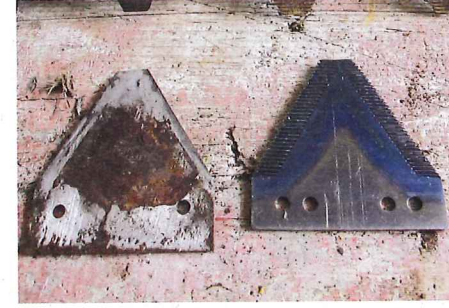
... verschlagenen Niet. Zwei Klingen, einmal glatt, die andere gezahnt. Sie unterscheiden sich auch in der Länge und von den Bohrungen
