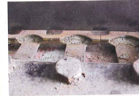
... abgebrochen (rechter Finger). Streckenweise sieht die Anordnung der Finger aber ordentlich aus – bis auf Schmutzablagerungen und Rost
