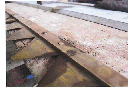
... den Messerhaltern am Fingerbalken, da müssen die Niete glatt verschliffen sein. Auf der Unterseite ist ein Millimeter in der Regel ...
