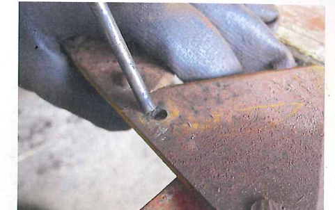
... verrutscht die Klinge nicht. Falls erforderlich, wird die Bohrung entgratet. Zum erneuten vernieten kommt Thomas erst im nächsten Teil
