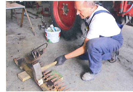
Ein weiterer Klotz kommt als „Schlagschutz“ zum Einsatz, er wird mittig zwischen die Markierungen platziert, dann schwingt ...
